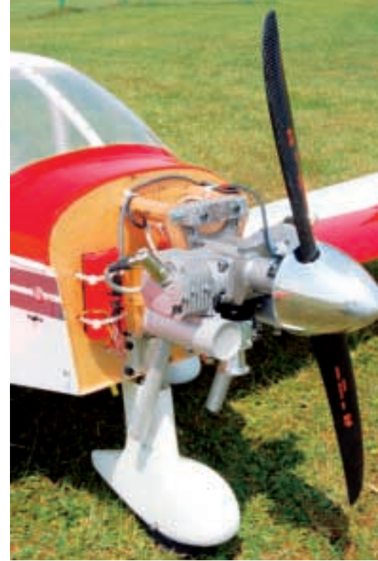
Nach der ersten Laufstunde verrichtet der Boxer nun seine Arbeit in der 2.400 Millimeter spannenden Robin DR400 von pp-rc Modellbau
